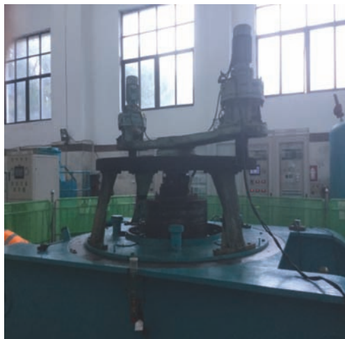
图 1 水电机组自动盘车现场
