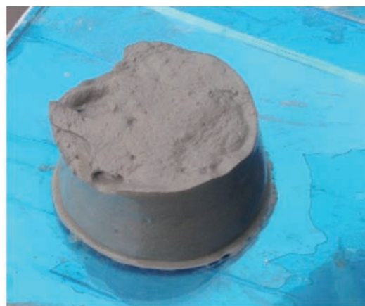
(b) 黏土水泥膏浆静置(流动度60mm)
