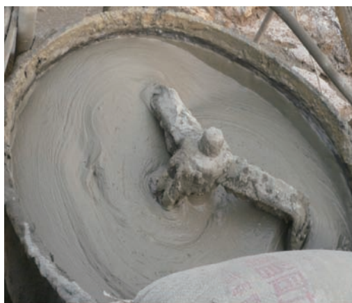
(a) 黏土水泥膏浆搅拌后(流动度60mm)
