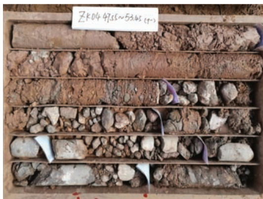
图7 挤压破碎带岩芯及挤压擦痕
