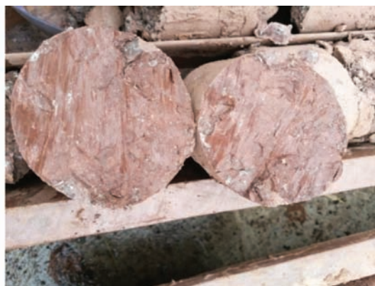
图7 挤压破碎带岩芯及挤压擦痕
