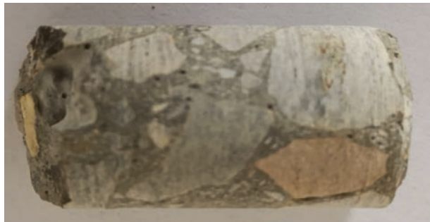
图6 裂缝处跨缝芯样(裂缝已充填密实)
