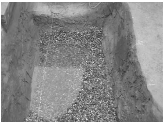
图 4 消能防冲工况下游冲坑现状
