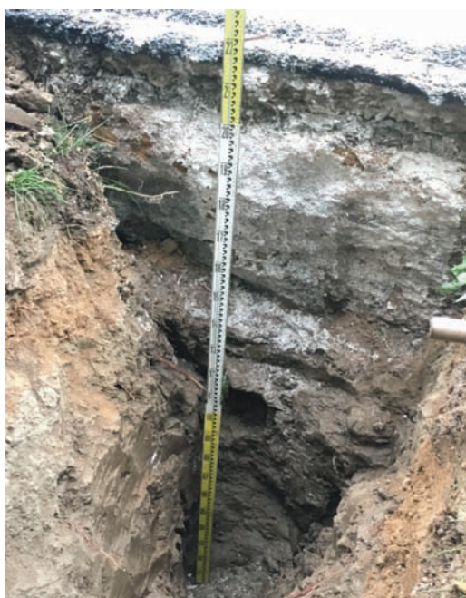
图7 东闸段道路裂缝探坑
