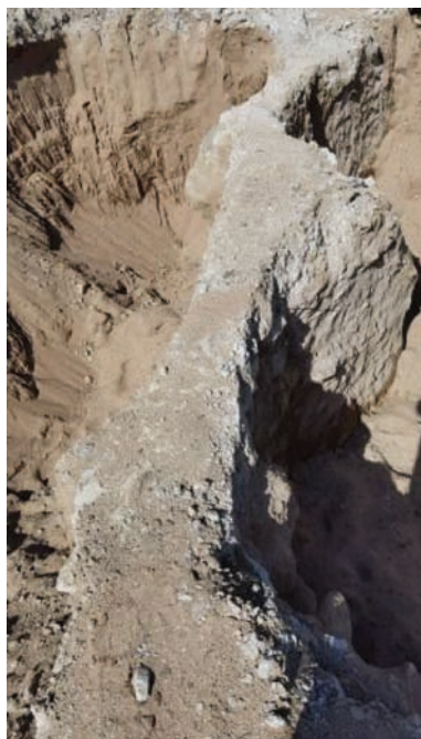
图 3 第二次围井试验开挖检查
