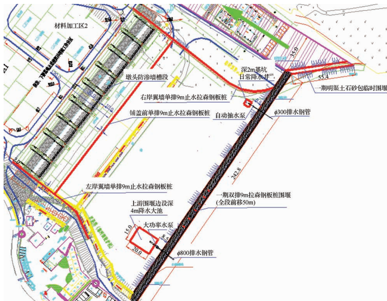
图 9 上游围堰及防渗措施布置(尺寸单位:m)
