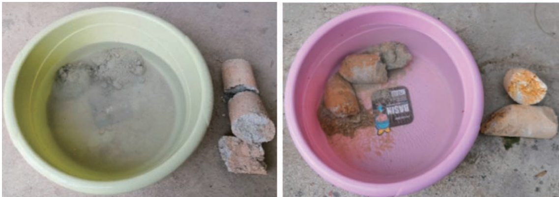
图4 全风化(左)、强风化(右)蚀变花岗岩浸水试验
