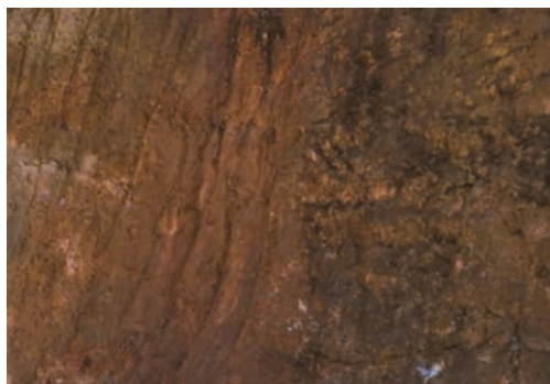
图 1 坝址区全风化蚀变花岗岩
