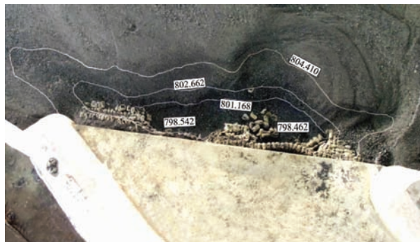
图 5 Q = 559\text{m}^3/\text{s} 典型流量历时 3h10min 后泄洪槽下游冲刷形态
