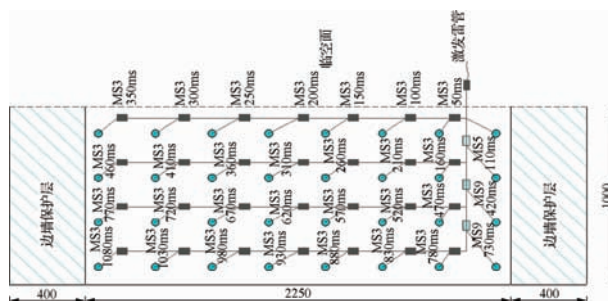
图7 小夹角部位中槽开挖装药联网图(单位:cm)
