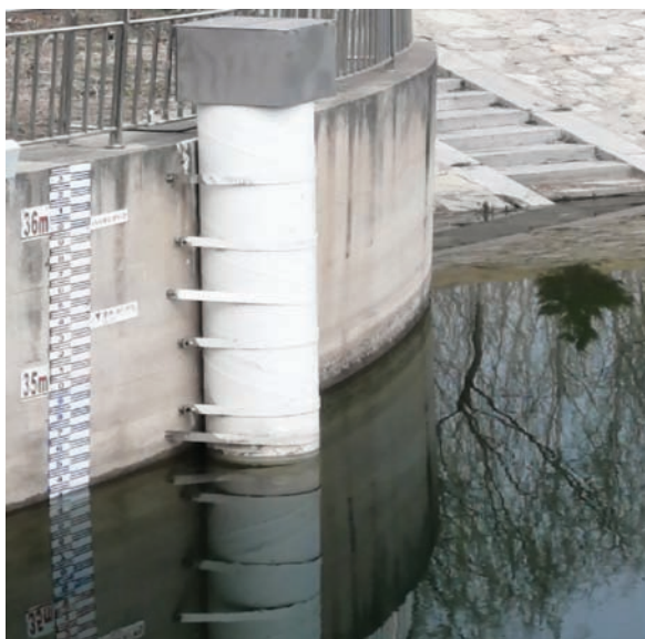
图4 浮子水位计实际安装效果
