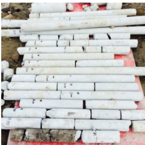
图 11 施工完成达到龄期后钻芯取样
