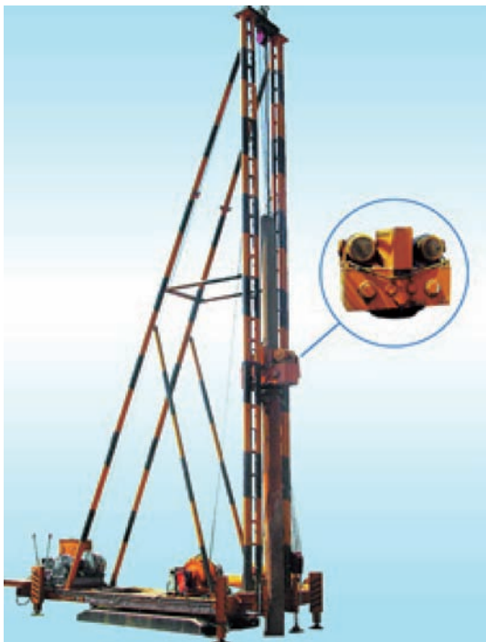
图3 步履式落锤载体桩机
