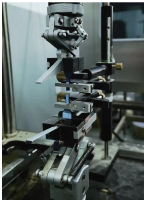
图2 坝袋胶料拉伸试验
