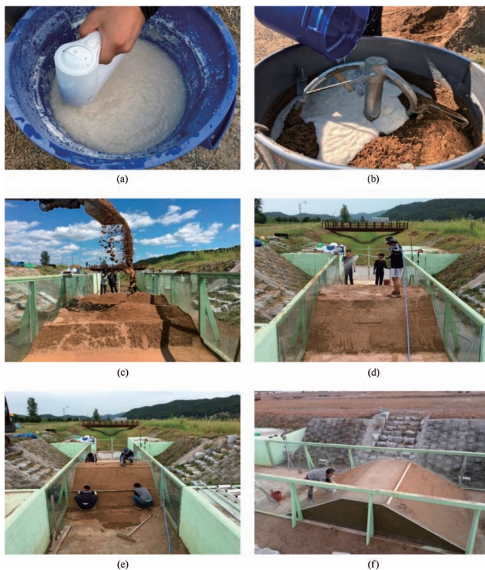
图4 使用生物聚合物覆盖试验堤坝过程示意图
