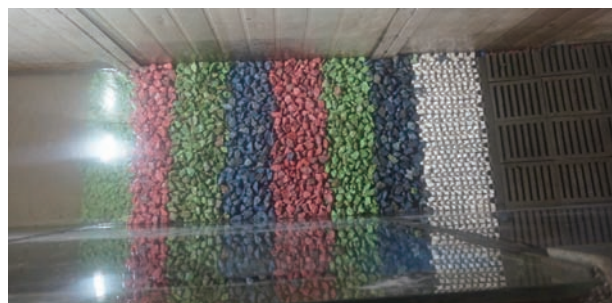
图4 波浪断面物理模型试验中扭王字块
